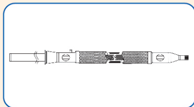
▲ 连接液氮槽车气相管线
